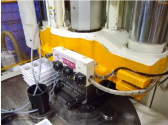
インサート成形を行う縦型成形機
