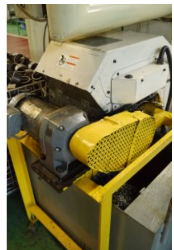
手作りのチップクラッシャー (鉄屑の粉碎機)
