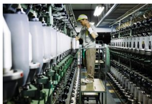
昔ながらの機械を使う 撚糸（ねんし）工程
