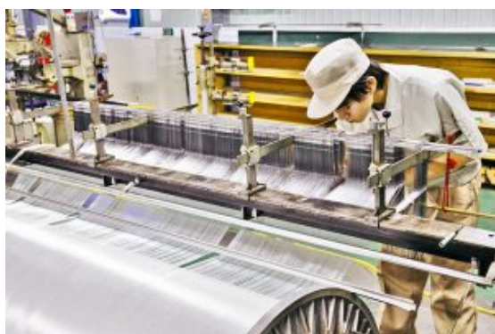
引込（ドローイング）工程の作業風景
